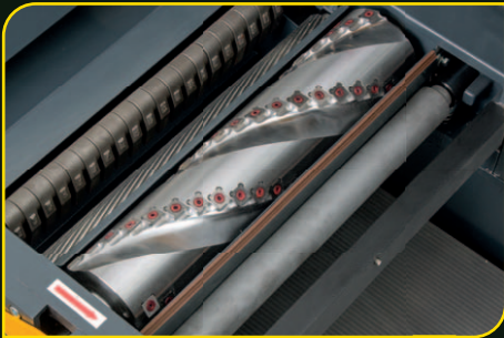
Spirálový válec s podávacími válci
