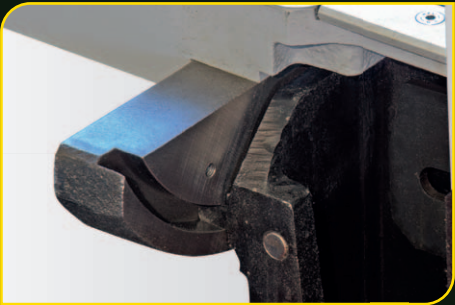
Masivní uložení mechaniky pily
