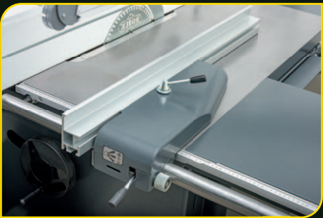
Podélné pravítko s jemným doladěním
