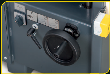
Zdvih protahovacího stolu s indikátorem
