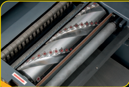
Spirálový válec s podávacími válci
