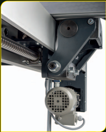
Motorický posuv podélného pravítka NC 3 osy
