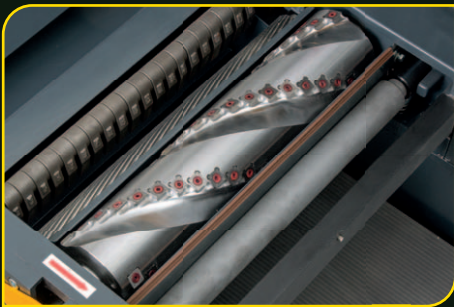
Spirálový válec s podávacími válci
