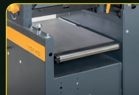
Odlehčovací válečky protahového stolu
