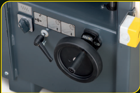
Zdvih protahovacího stolu s indikátorem
