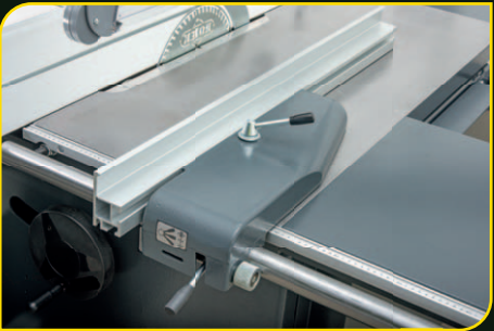
Podélné pravítko s jemným doladěním
